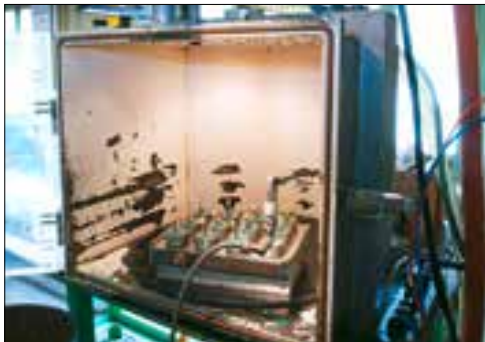
Unter Vakuum wird das Kunstharz in die Formen mit den Spulen für Netzgeräte gegossen.
