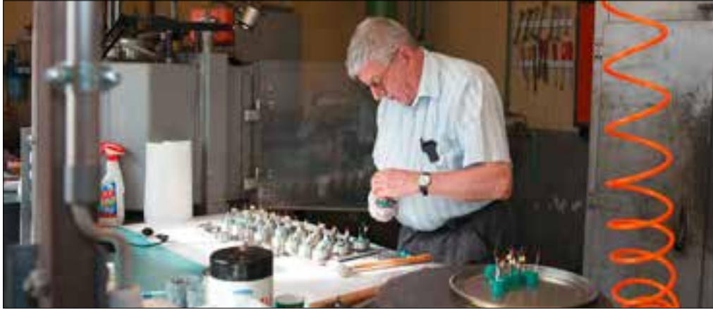
Handarbeit: Hans Ruedi Müller beim Ausformen der mit Kunstharz umgossenen Elektronikkomponenten.
