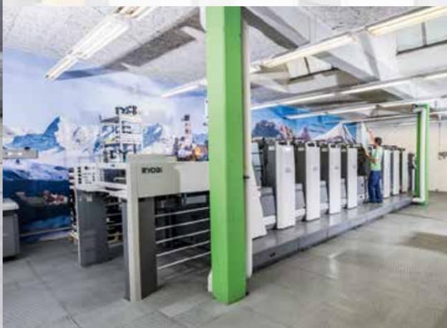
Neue Technologie: die 8-Farben-Druckmaschine.
