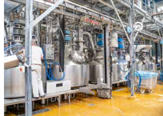
Fruchtgrundstoffe werden in Vakuum-Kochkesseln produziert.
