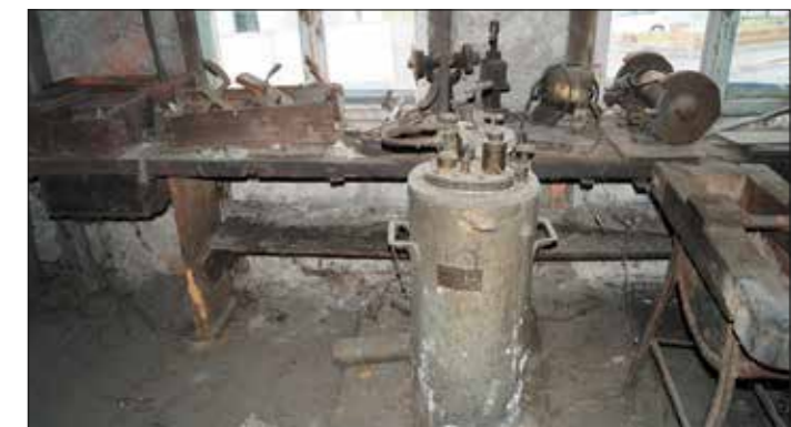
Acetylen-Gas-Anlage. Mit Karbid und Wasser entstand Gas für Schweissarbeiten.
