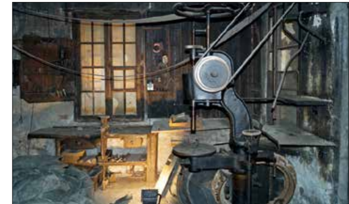
Maschine für Schlosserarbeiten, angetrieben über Elektromotor und Transmission.
