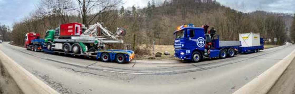
Der Schweizer Konvoi, welcher die schwere Baumaschine und den Baucontainer auf eine Baustelle nach Tschechien transportierte.
