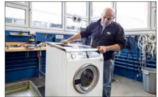
Bevor der Deckel endgültig auf die Waschmaschine kommt, durchlaufen die Geräte einen intensiven Test-Waschgang (links).
