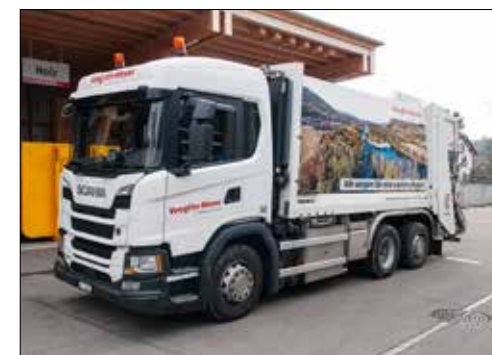
Abfallsammelwagen «Waschbär» mit Container-Reinigungsanlage.
