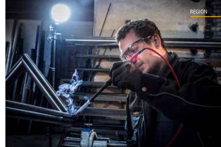
Mischa Lüthi bei der Arbeit in der Werkstatt an der neuen Bahnhofstrasse in Menziken: Das Schweißen von Chromstahl und die Nachbearbeitung erfordern Know-how und Präzision.
